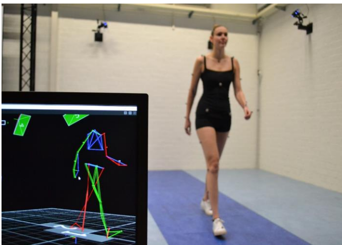
Afbeelding 3: Deze vrouw loopt in het bewegingslab van het Radboudumc. Aan de muur zie je 2 speciale camera's hangen. Deze camera's filmen de bolletjes die op de benen en armen van deze vrouw zijn geplakt. Op de computer wordt er een lijnfiguur van de bolletjes gemaakt (linksonder in beeld). De rode lijnen op het computerscherm zijn de linkerarm en het linkerbeen van de vrouw. De groene lijnen zijn de rechterarm en het rechterbeen van de vrouw. Ook zijn in het grijs de krachtplaten zichtbaar en laat de rode pijl vanuit de grond de richting en mate van kracht vanuit de vloer zien. Je ziet dat de vrouw op de foto met haar rechterbeen voor staat; het lijnfiguur staat dan ook met het rechterbeen (groen) voor.
