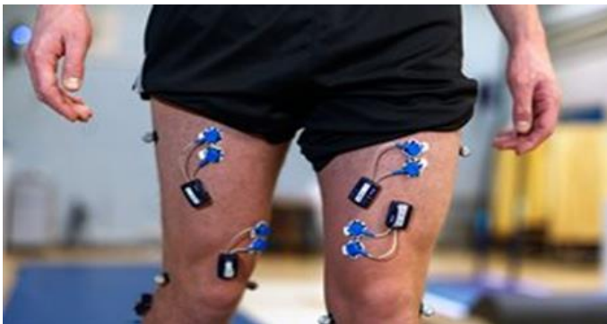
Afbeelding 2: Op de foto zie je de markers, de kleine grijze bolletjes. Zij hebben een speciale reflecterende laag. Ook zie je de gel-plakkers met de EMG-kastjes (de zwarte kastjes met de draadjes).
